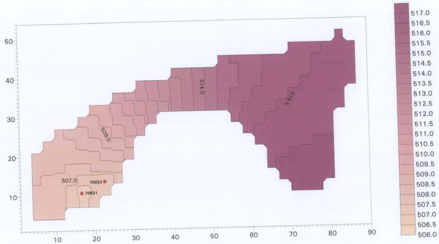
Figura 5.29: Isopiezas correspondientes a la capa 1. Solución del régimen estacionario en Diciembre de 1996.
